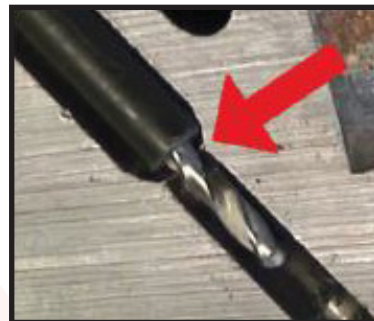
Tope para las brocas. No se puede dañar la culata.
